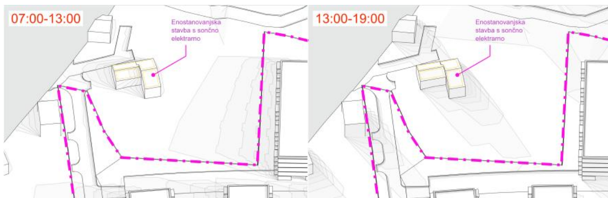
Slika 21: Osončenost severnega dela na poletni sončev obrat (20.6.): levo od 7:00 do 13:00 (6 ur), desno od 13:00 do 19:00 (6 ur), vir: Geoplan
