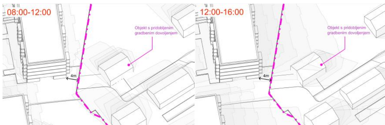
Slika 8: Osončenost severovzhodnega dela na pomladansko enakonočje (21.3.): levo od 8:00 do 12:00 (4 ure), desno od 12:00 do 16:00 (4 ure), vir: Geoplan
