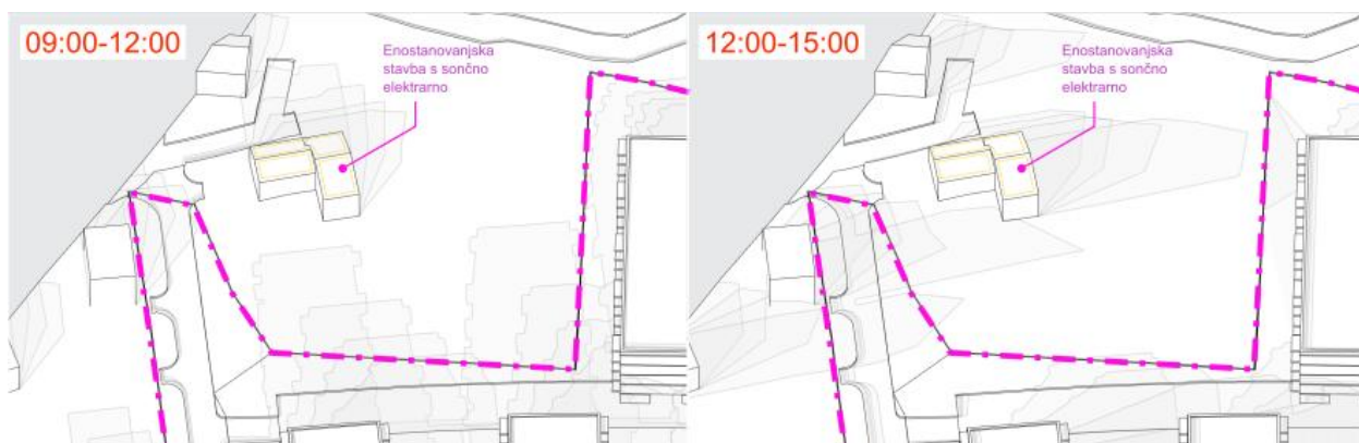
Slika 19: Osončenost severnega dela na zimski sončev obrat (21.12.): levo od 9:00 do 12:00 (3 ure), desno od 12:00 do 15:00 (3 ure), vir: Geoplan
