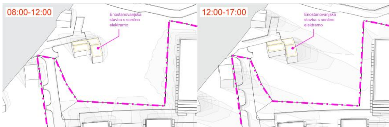
Slika 20: Osončenost severnega dela na pomladansko enakonočje (21.3.): levo od 8:00 do 12:00 (4 ure), desno od 12:00 do 17:00 (5 ur), vir: Geoplan
