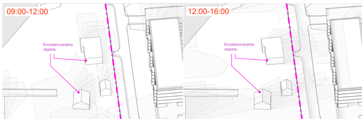
Slika 15: Osončenost zahodnega dela na zimski sončev obrat (21.12.): levo od 9:00 do 12:00 (3 ure), desno od 12:00 do 16:00 (4 ure), vir: Geoplan
