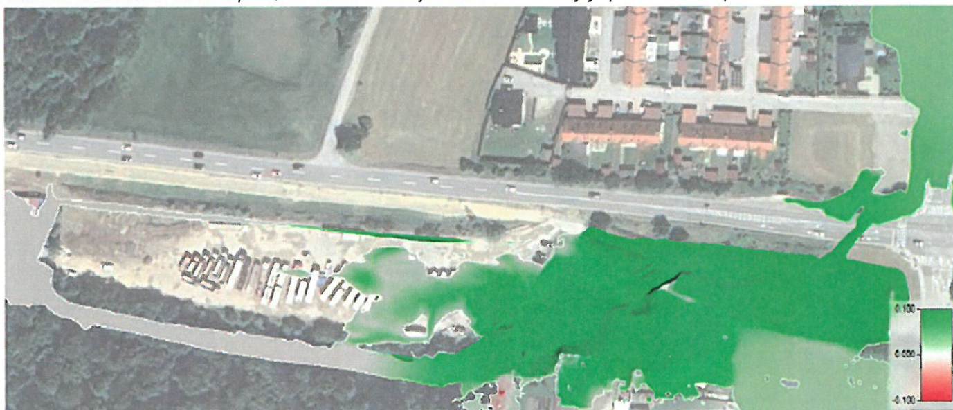
Slika 20: Primerjava gladin med obstoječim in načrtovanim stanjem, kjer zelena barva prikazuje znižanje gladin in rdeča barva povišanje le-teh.
