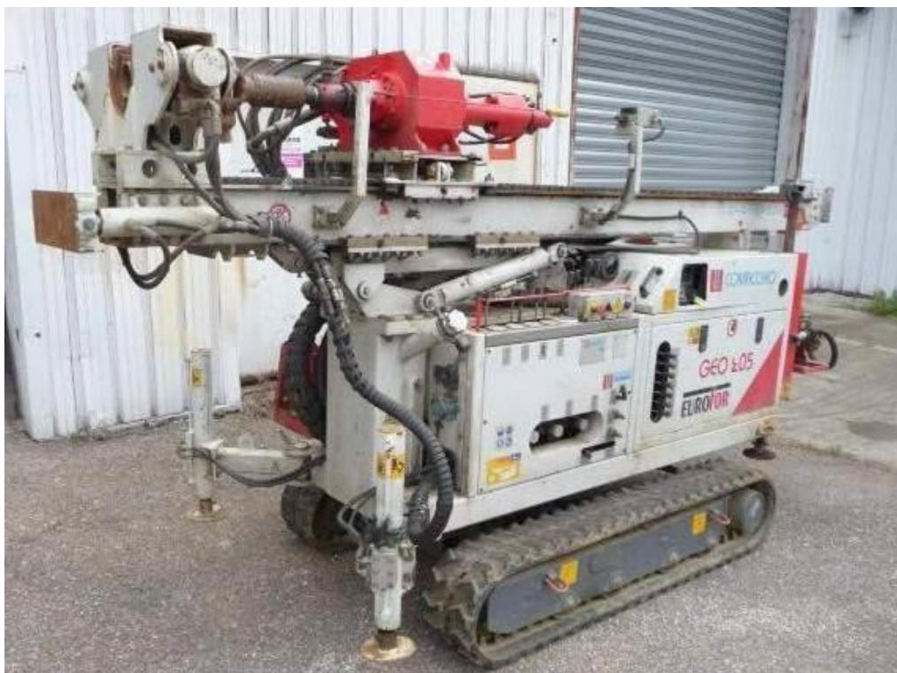
Slika 4: Vrtalna garnitura Comacchio 205
