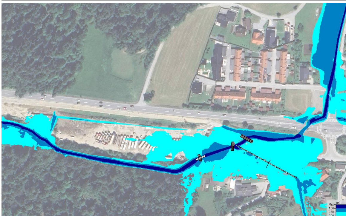
Slika 15: Rezultati za pretoke Q100 Trebušnice za obstoječe stanje.
