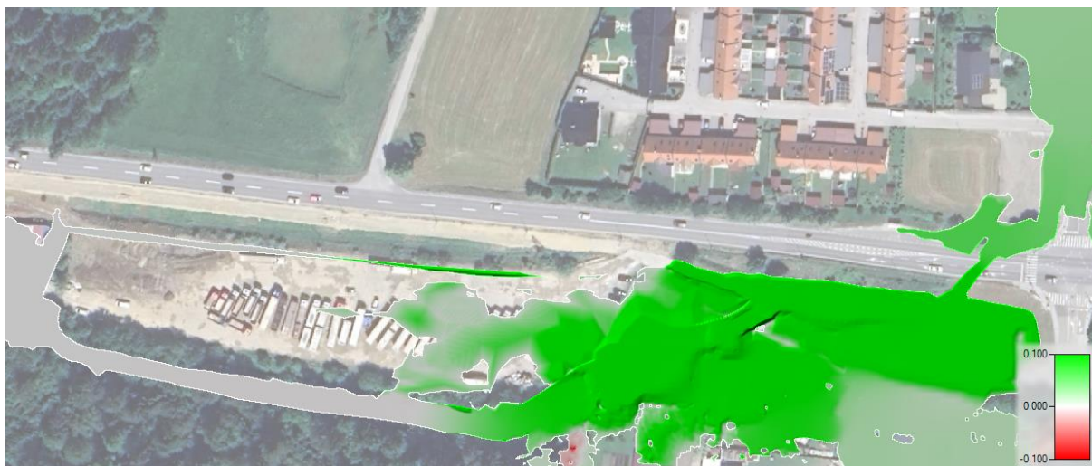
Slika 19: Primerjava gladin med obstoječim in načrtovanim stanjem, kjer zelena barva prikazuje znižanje gladin in rdeča barva povišanje le-teh.
