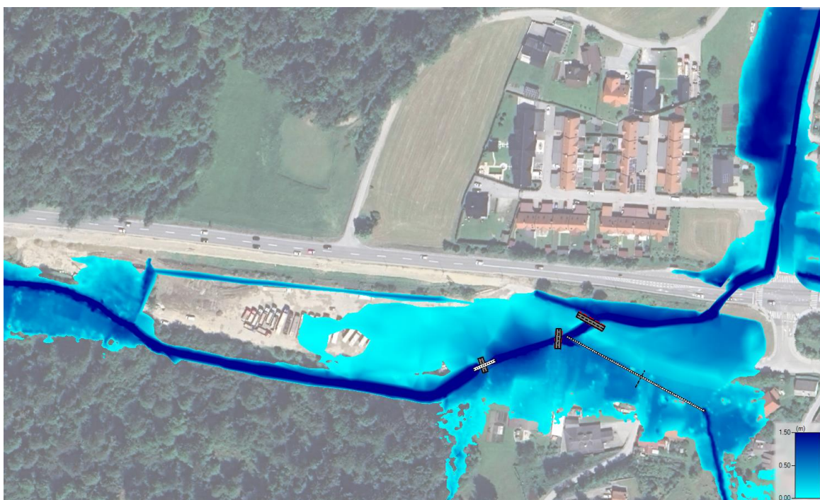
Slika 16: Rezultati za pretoke Q500 Trebušnice za obstoječe stanje.
