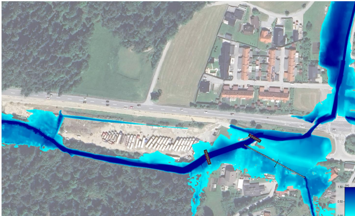
Slika 20: Rezultati za pretoke Q500 Trebušnice za načrtovano stanje.
