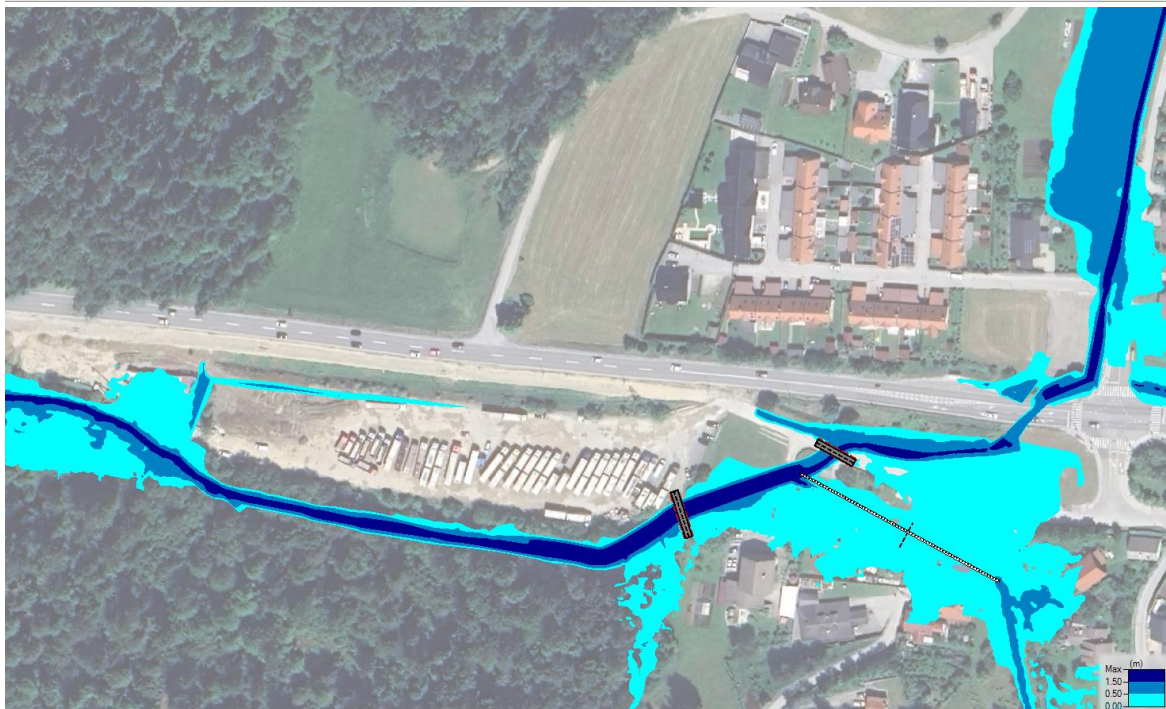
Slika 18: Rezultati za pretoke Q100 Trebušnice za načrtovano stanje.
