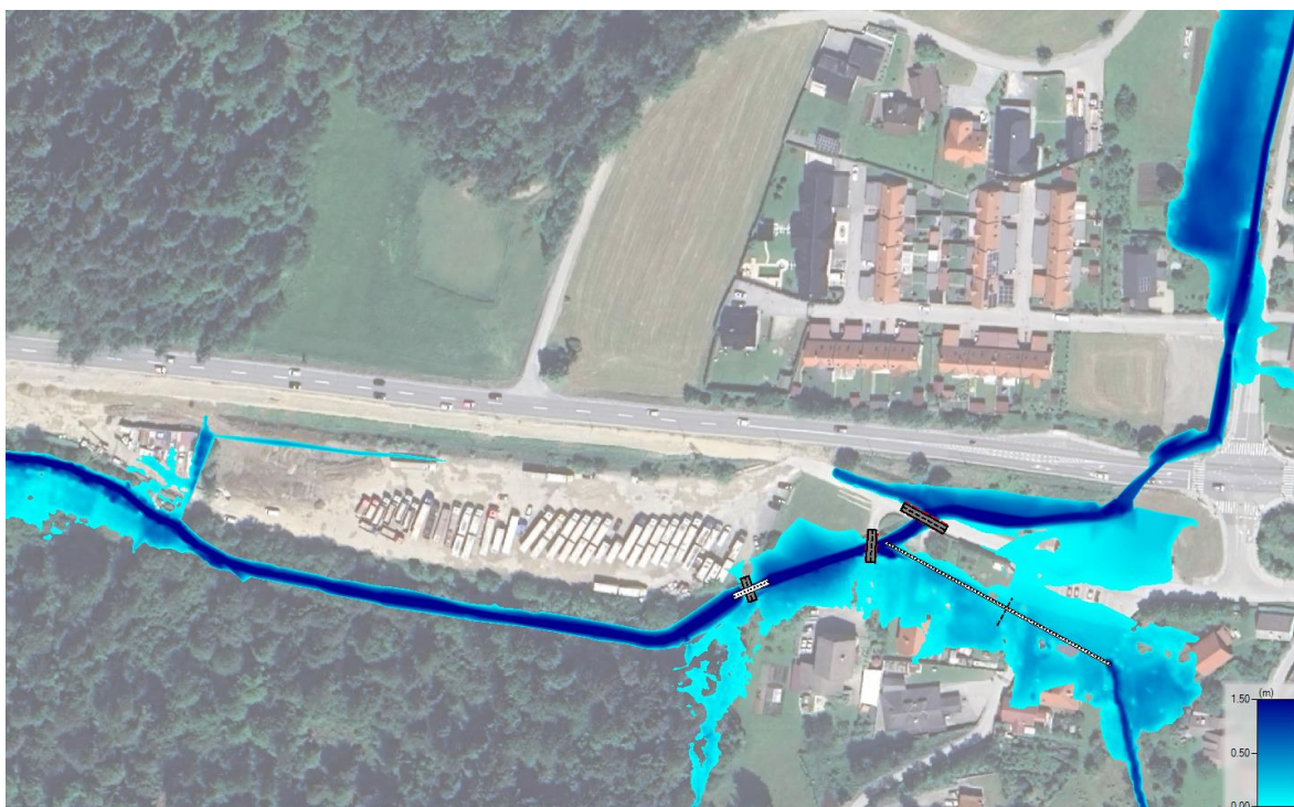
Slika 14: Rezultati za pretoke Q10 Trebušnice za obstoječe stanje.
