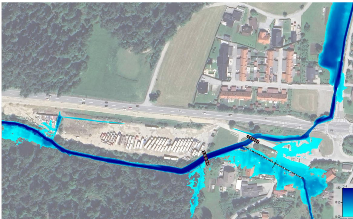
Slika 17: Rezultati za pretoke Q10 Trebušnice za načrtovano stanje.
