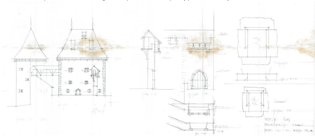
Stavbna faza s pravokotnim in okroglim stolpom. Fasade, spodaj prerez in detajli. Hrani RP.
