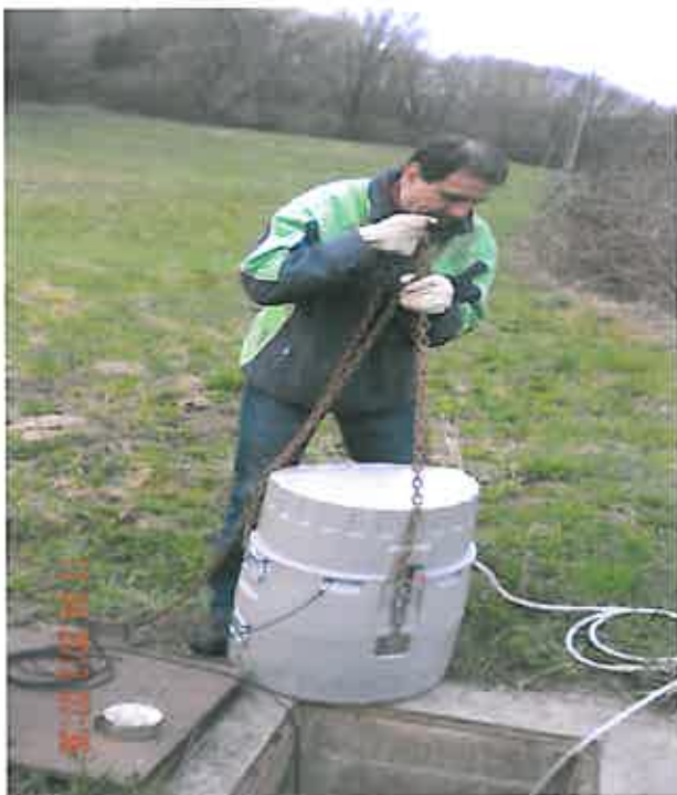
Slika 9: Priprava na meritev izcednih voda
