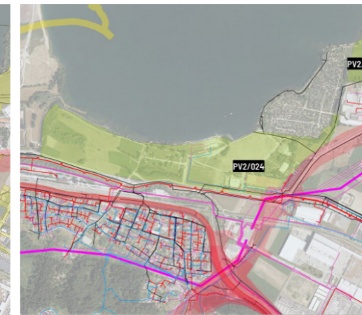
Infrastruktura: električna, voda, kanalizacija, vročevod
